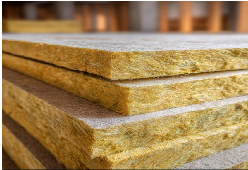
3-rasm. Bazalt asosidagi issiqlik izolyatsiya plitalarining ko'rinishi
